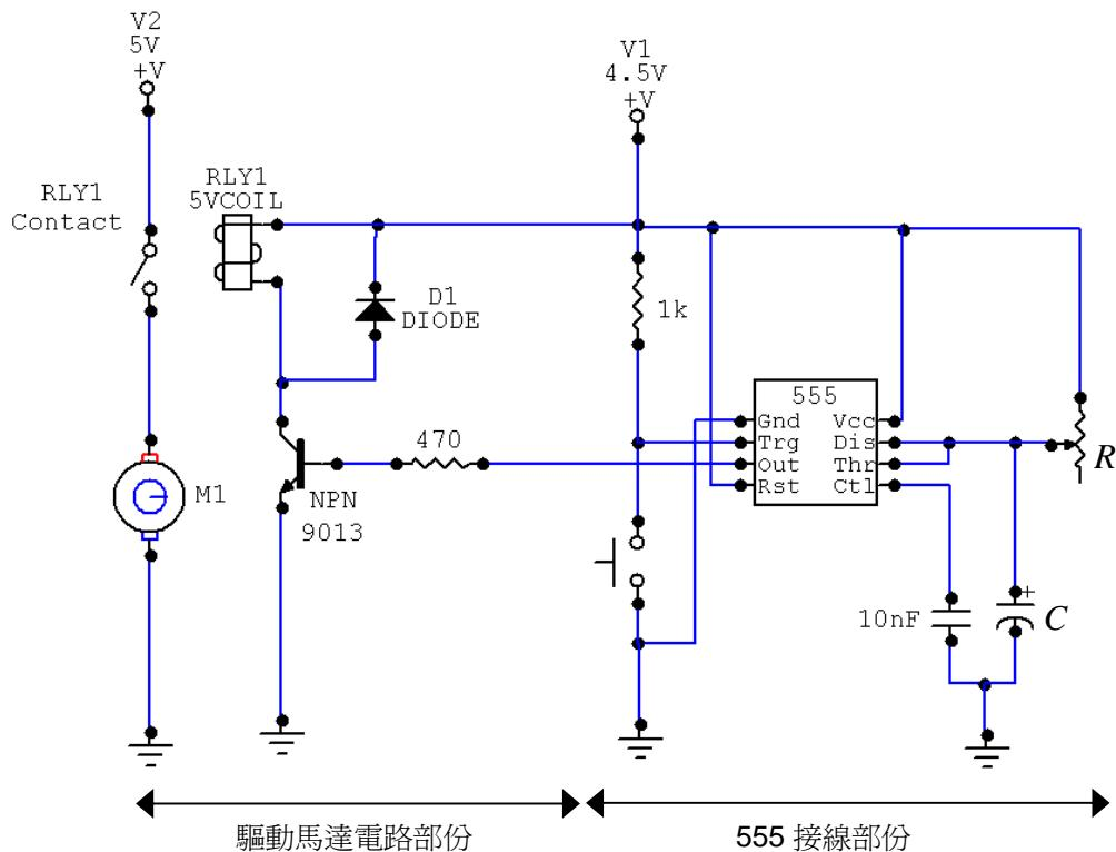
【圖 4】控制直流馬達轉動時間的電路圖
